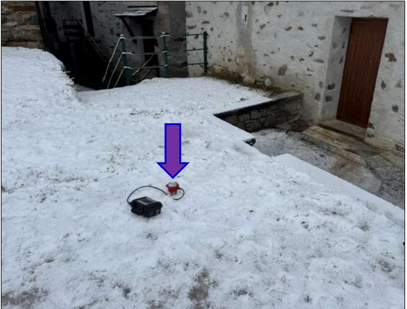
Fig. 11 – Documentazione fotografica del punto di esecuzione dell'indagine di sismica passiva HVSR con strumentazione ECHO TROMO HVSR 3
